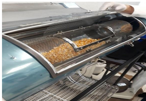
Figura 1.- Prototipo de luz UV-C empleado para la irradiación del grano de maíz amarillo, diseñado en ESIME-Zacatenco (2018).
