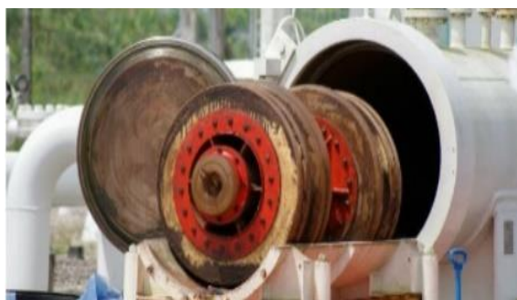
Figura 3.- Pig al finalizar operación. (NiGen, 2023).
