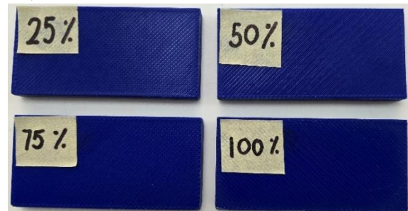
Figura 2.- Muestras con diferentes densidades de relleno de impresión.
