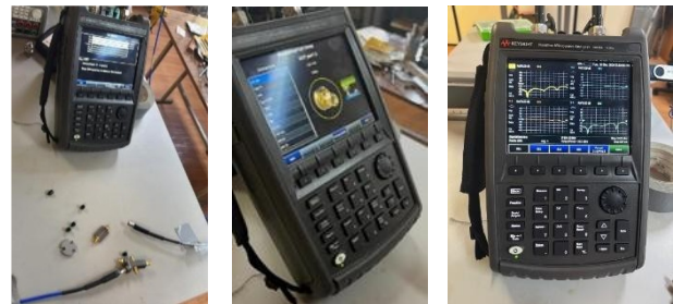
Figura 3.- Medición de la línea de transmisión con conectores SMA, mediante el equipo KEYSIGHT.
