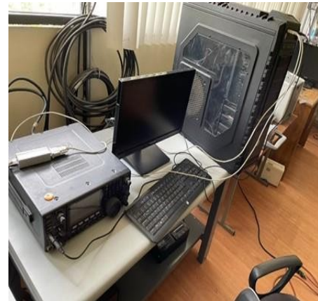
Figura 6 PC para uso de aplicaciones de seguimiento satelital y decodificación de señales
